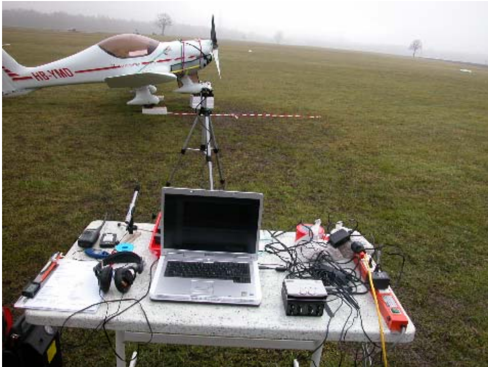
Anordnung Flugzeug und Mikrophon, Messausrüstung
