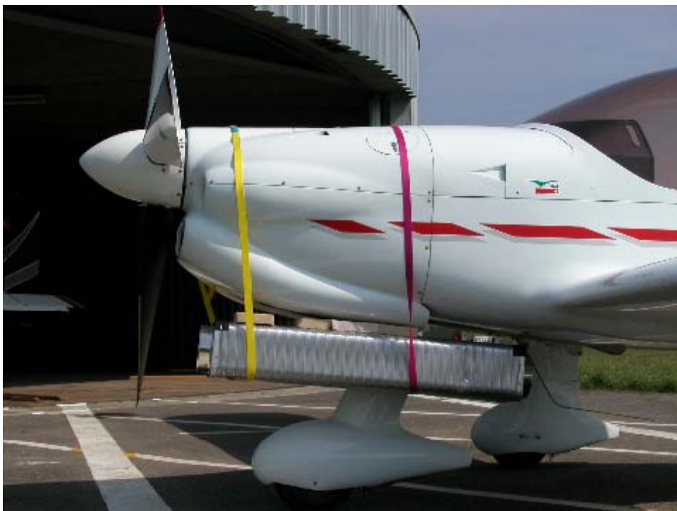
Vorversuch mit Absorberrohr als Nachschalldämpfer
