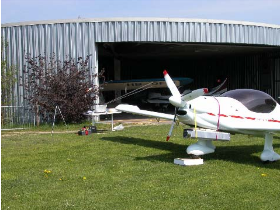
Vorversuch mit Absorberrohr als Nachschalldämpfer
