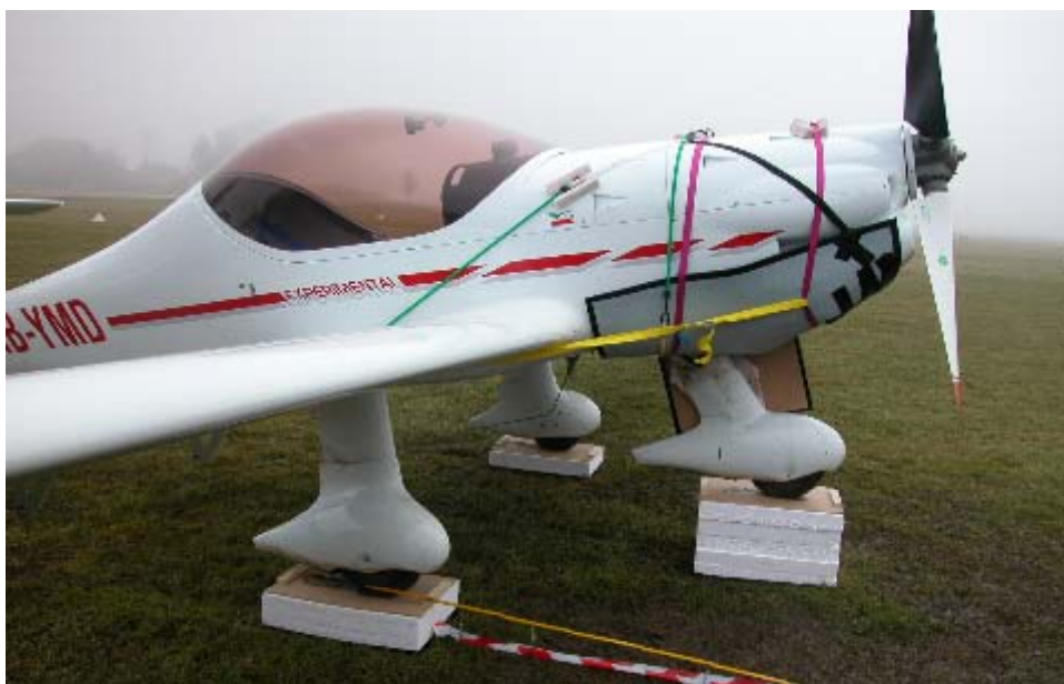
Vorversuch mit Schwermatte als Cowlingdämpfung
