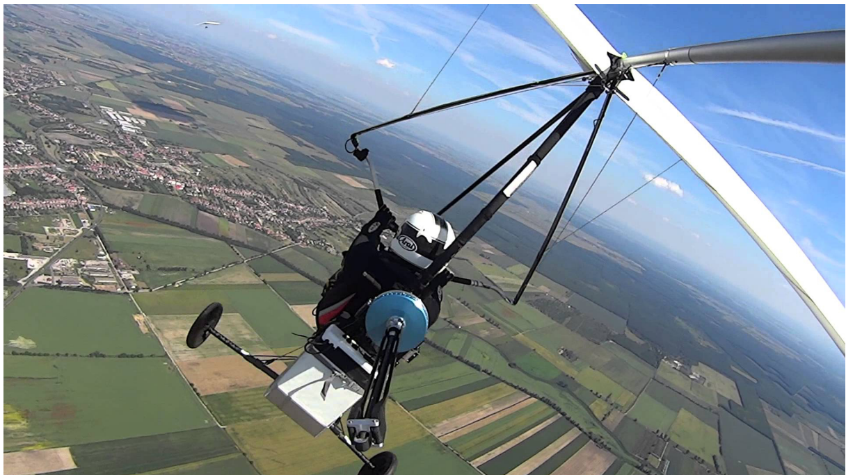
Umweltfreundliches, effizientes Fliegen dank Elektromotor und Klapppropeller
