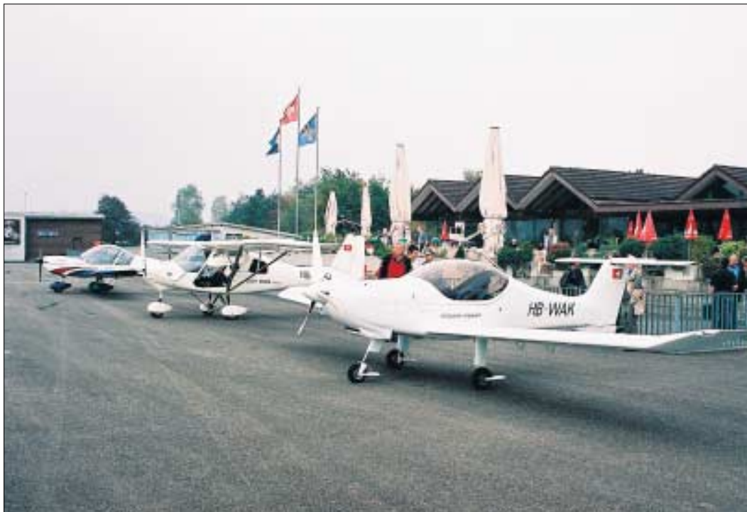
Drei Ecolight-Schleppflugzeuge im Birrfeld, von vorne: MCR 01 (115 PS), C 42 (100 PS) und Eurostar (100 PS). Das «W» zu Beginn der Immatrikulation verrät das Ecolight-Flugzeug.
